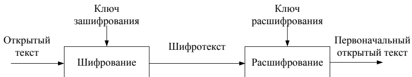
Рисунок 4 – Шифрование и расшифрование с двумя ключами
